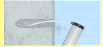
5. Austretender Verbundmörtel verwerfen, (ca. 10 cm), bis austretender Verbundmörtel gleichmäßig grau gefärbt austritt. Nicht richtig vermischter Verbundmörtel bindet nicht ab! Jetzt Bohrloch blasenfrei vom Bohrlochgrund her befüllen.
