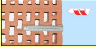
5. Siebhülse bündig in das Bohrloch einstecken.
